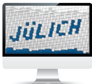
Dieser Schriftzug entstand Molekül für Molekül mithilfe der Spitze eines Rastertunnelmikroskops.
