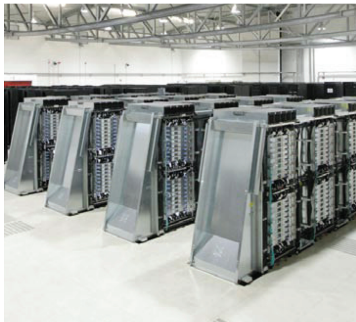
Verstaut in 16 Racks, machten über 65 000 Prozessoren JUGENE bei Inbetriebnahme zum schnellsten zivilen Supercomputer der Welt.
